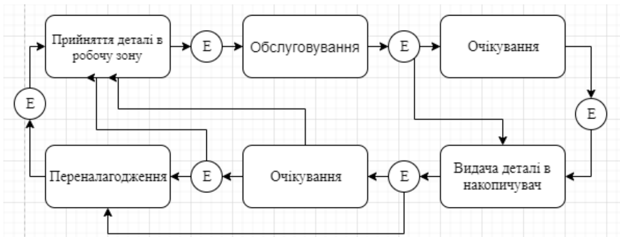
Рисунок 3.2 – Графи станів блоку обслуговування
