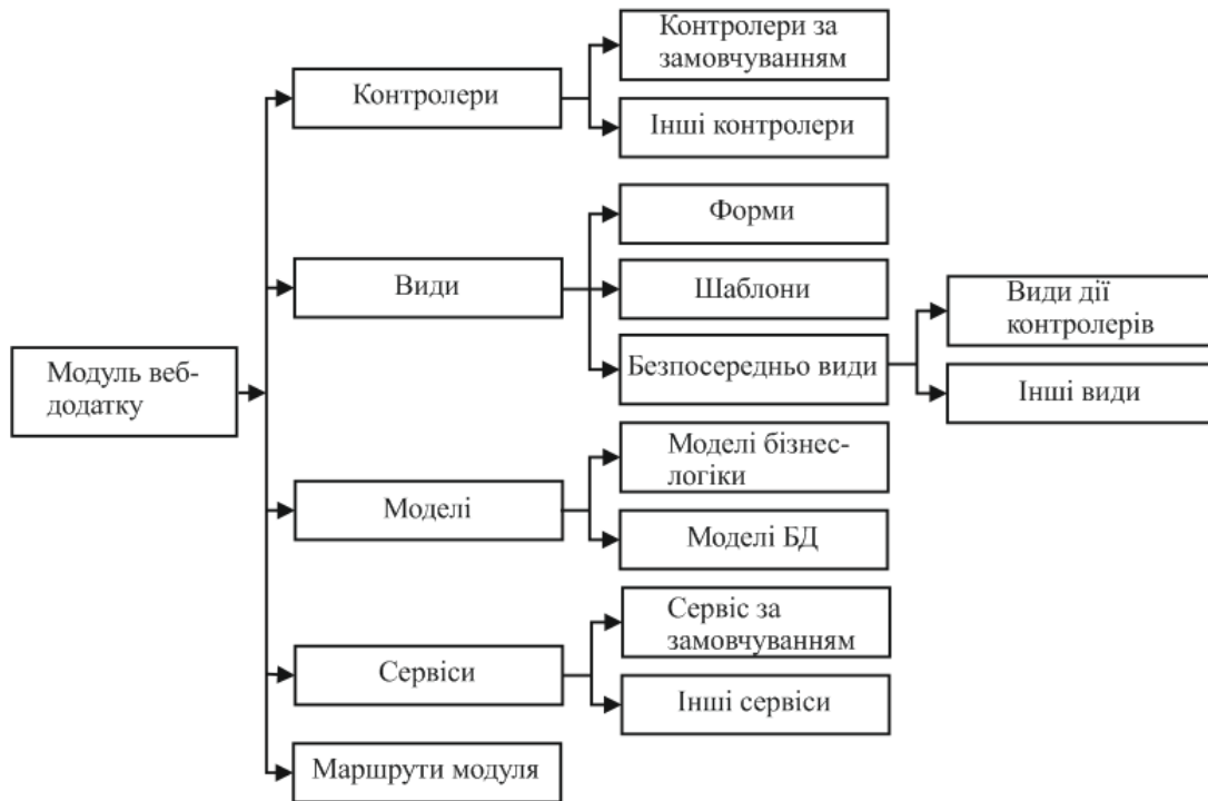
Рисунок 4.1 – Загальна структура модуля вебзастосунку
