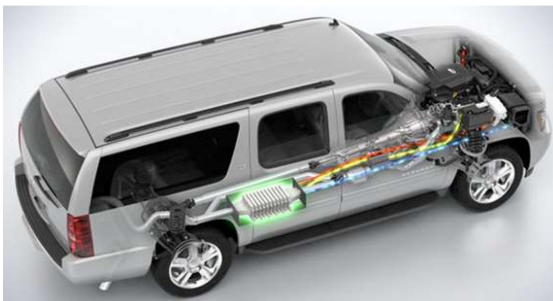
Рисунок 1.6 – Схема встановлення термогенераторного пристрою у автомобілі
