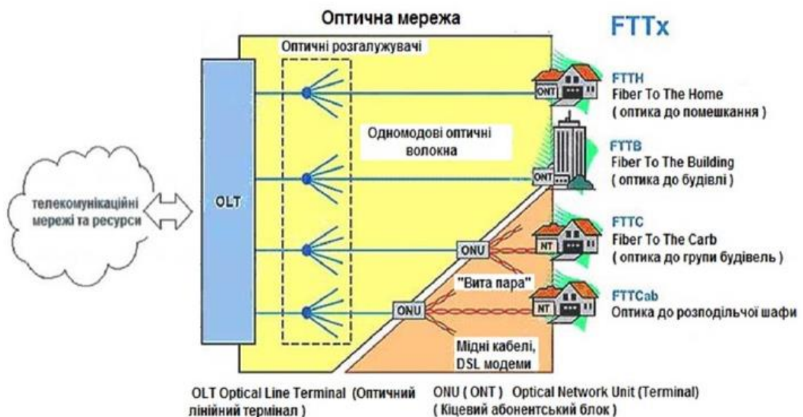
Рисунок 1.4 – Схема оптичної мережі з поєднанням PON та FTTx
