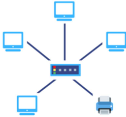
Рисунок 2.1 - Топологія мережі «Зірка»
