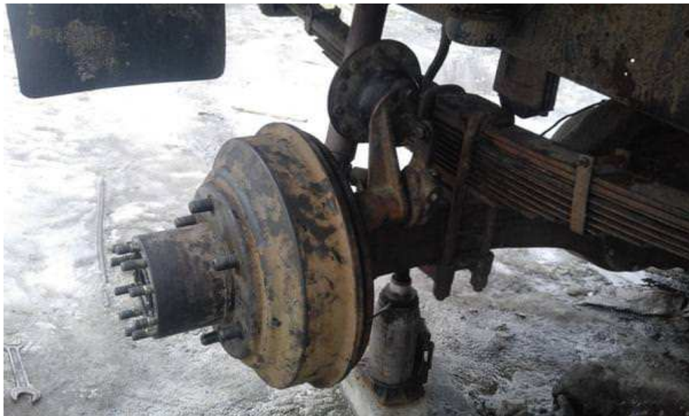
Рисунок 1.7- Обслуговування гальмівної системи
