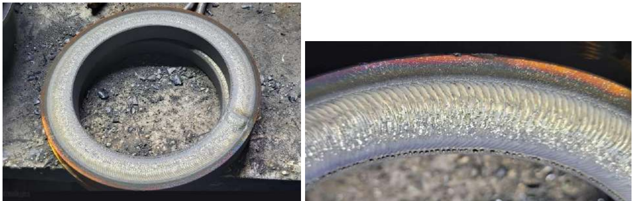
Рисунок 2.4 – Поверхня деталі з кільцевою геометрією, яка має характерний рельєф від плазмово-порошкового наплавлення металу
