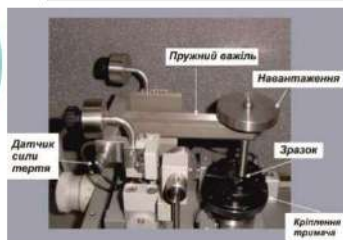
Рисунок 3 – Схема автоматизованої машини тертя
