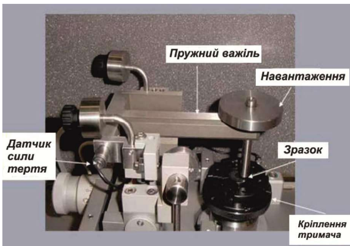
Рисунок 3.3 – Схема автоматизованої машини тертя (Tribometer, CSM Instruments)
