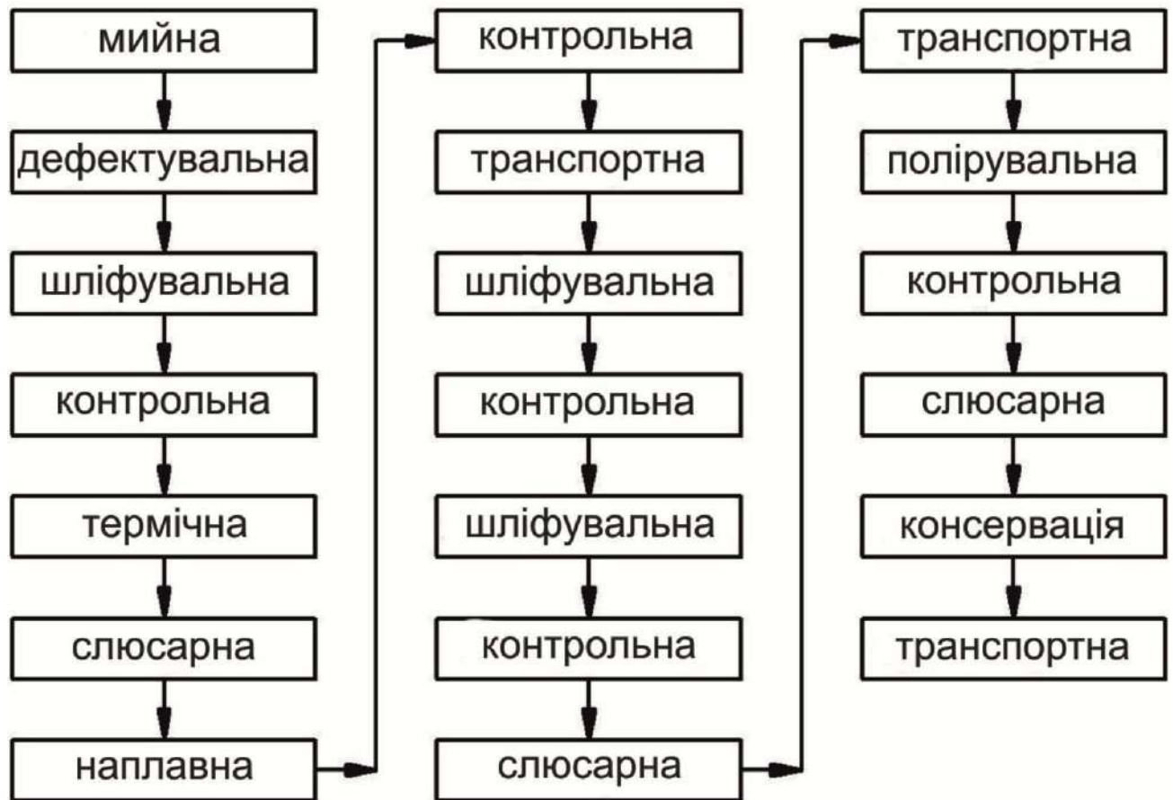
Рисунок 3.11 – Технологічний процес відновлення колінчастих валів плазмовим твердосплавним порошковим наплавленням
