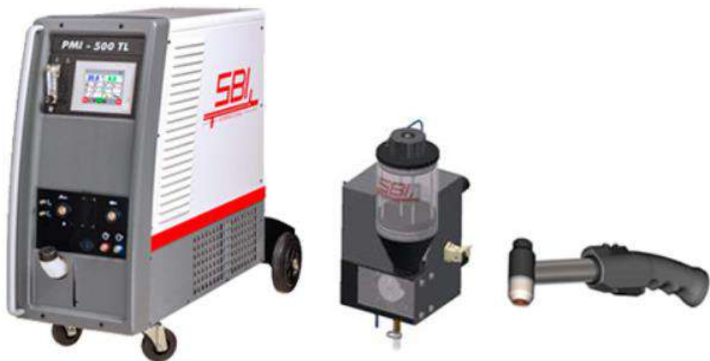
Рисунок 2.5 – Комплект обладнання для ручного наплавлення: апарат, порошковий живильник, плазмовий пальник [23]
