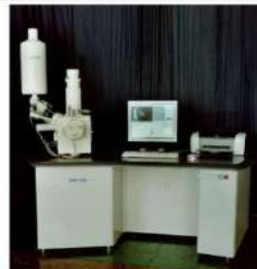
Рисунок 4 – Растровий електронний мікроскоп РЕМ-106
