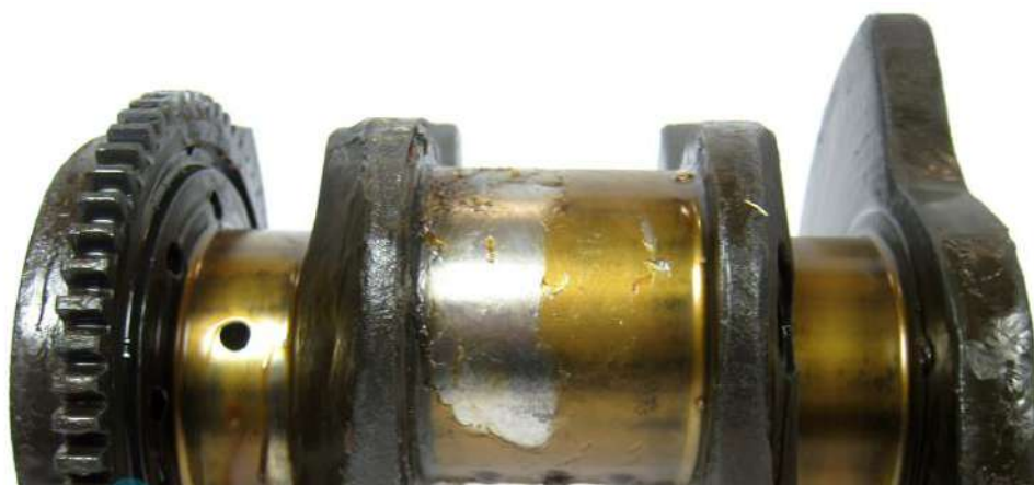
Рисунок 3.10 – Пошкоджена шийка колінчастого валу двигуна КамАЗ-740
