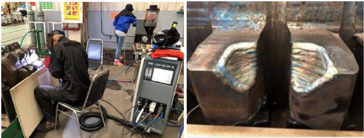
Рисунок 2.6 – Використання комплекту обладнання для ручного наплавлення [23]
