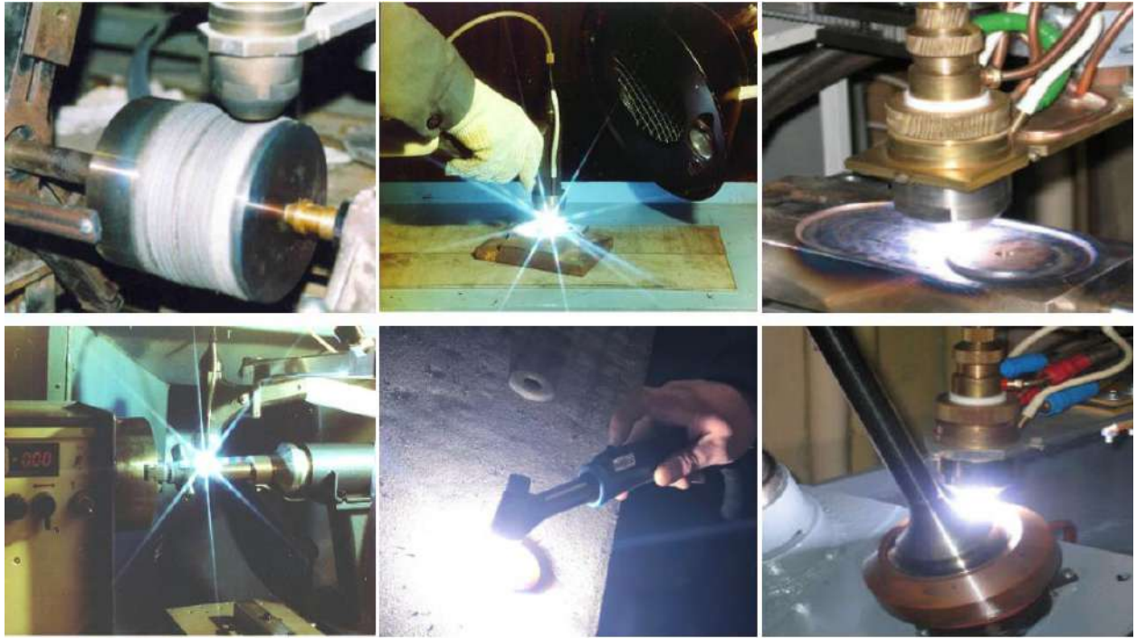
Рисунок 2.3. Процес плазмового наплавлення
