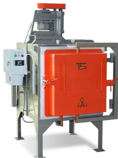
Рисунок 3.1 – Камерна піч із захисною атмосферою СНЗ-2,5.5.2,5/12,5 И2 Гк та вентилятором.
