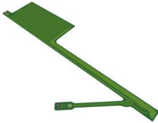
Рисунок 3.4 – Зворотна сторона гнучкої плати
