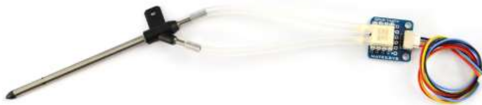
Рисунок 1.7 – Зібраний стан сенсора Matek ASPD 4525
