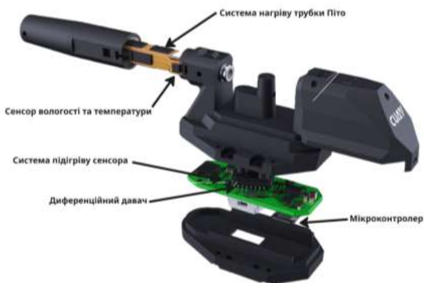
Рисунок 1.4 – Схема розташування компонентів на модулі СВПШ CUAV SKYE
