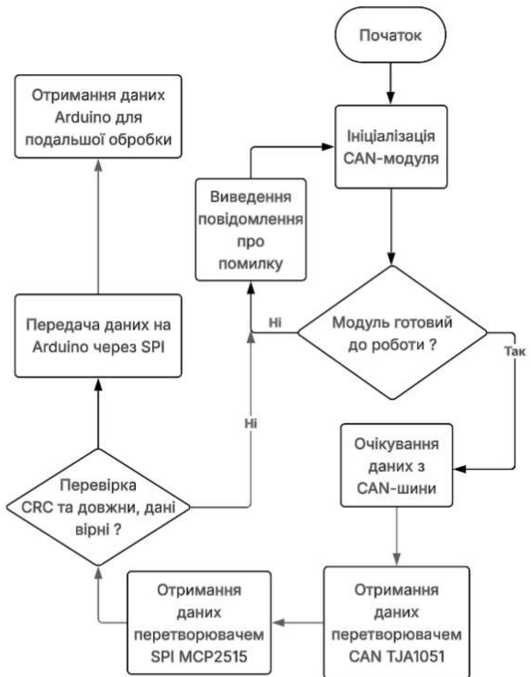
Рисунок 3.16 – Блок-схема обробки даних CAN-модулем
