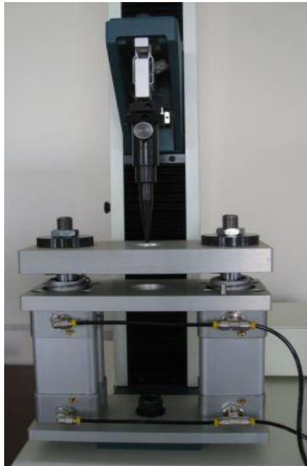
Рисунок 2.11 – Установка машины Tinius Olsen H5K-T для тестування бар'єрної плівки на стійкість до проколу
