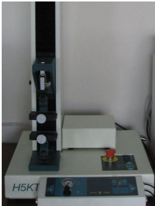
Рисунок 2.6 – Зовнішній вигляд розривальної машини Tinius Olsen H5K
