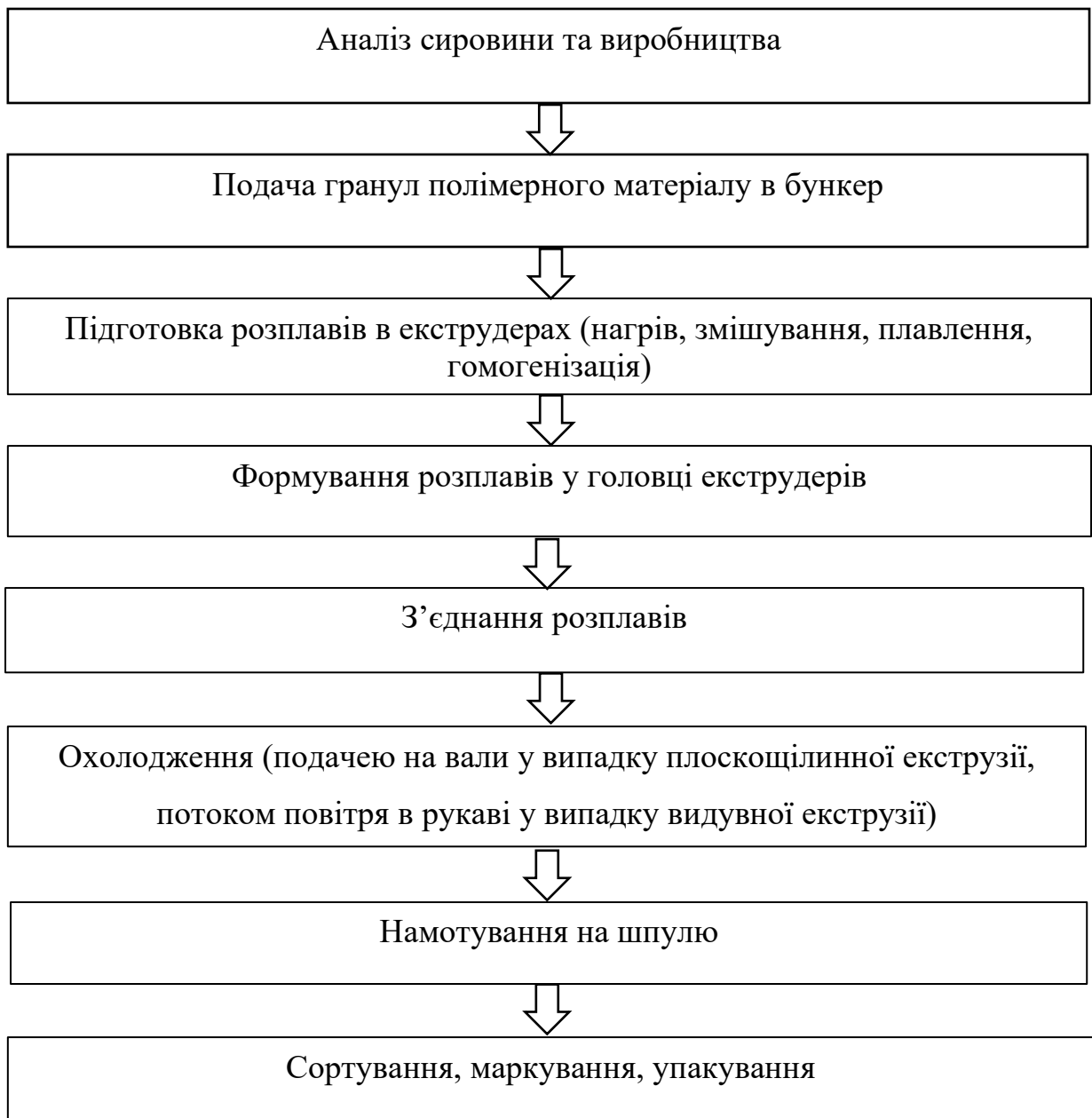
Рисунок 3.9 – Блок-схема виробництва семишарової бар'єрної плівки
