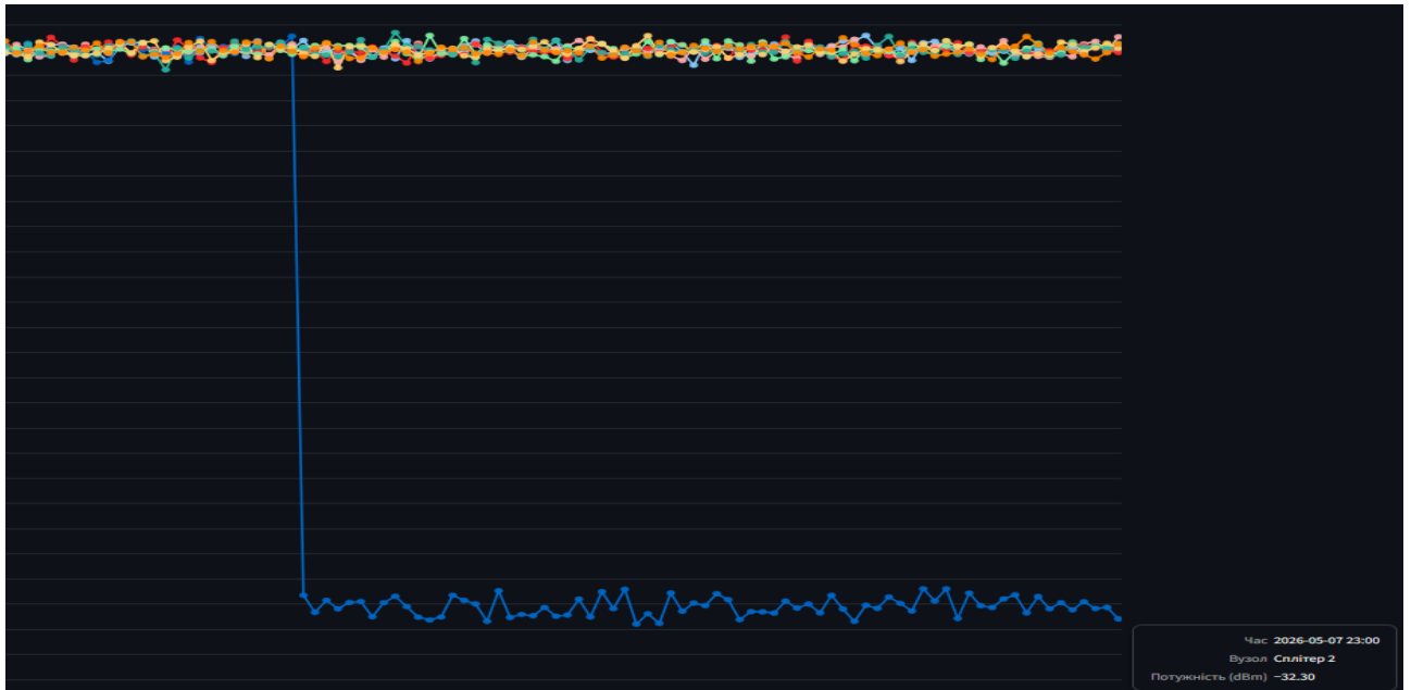
Рисунок 3.11 – Реакція системи на деградацію порту сплітера 2 (падіння потужності до межі -32 дБм)
