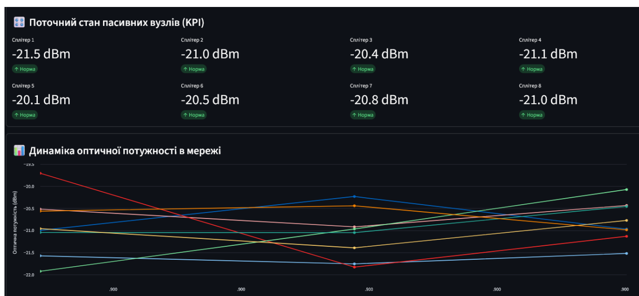
Рисунок 3.3 - Візуалізація роботи системи в режимі потокової симуляції телеметрії (Live-режим)
