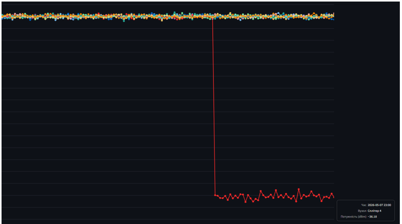
Рисунок 3.15 – Візуалізація критичного обриву магістралі сплітера №4 (повна втрата сигналу, рівень нижче -36 дБм)
