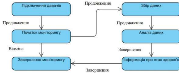
Рис. 3. Діаграма стадій системи моніторингу респіраторних захворювань в режимі реального часу з використанням Інтернету медичних речей
