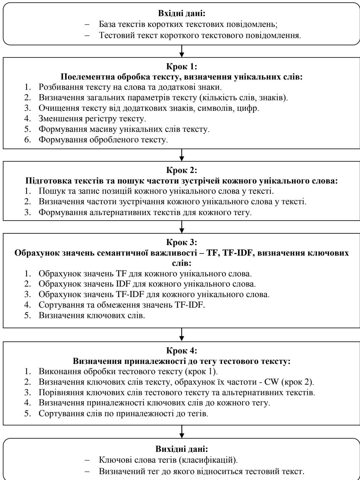
Рисунок 2.1 – Схема методу автоматизованої тематичної класифікації коротких текстових повідомлень
