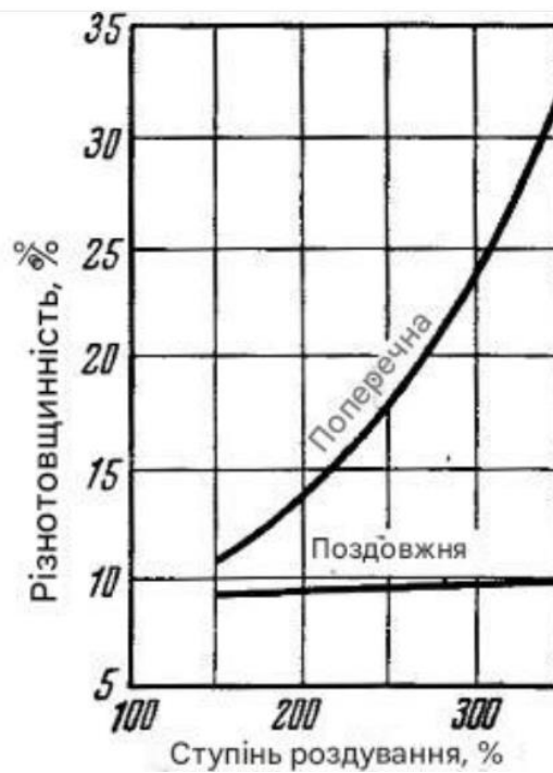
Рисунок 1.12 – Залежність від ступеню поперечного роздування пластику на товщинність плівки у поздовжніх та поперечних напрямках
