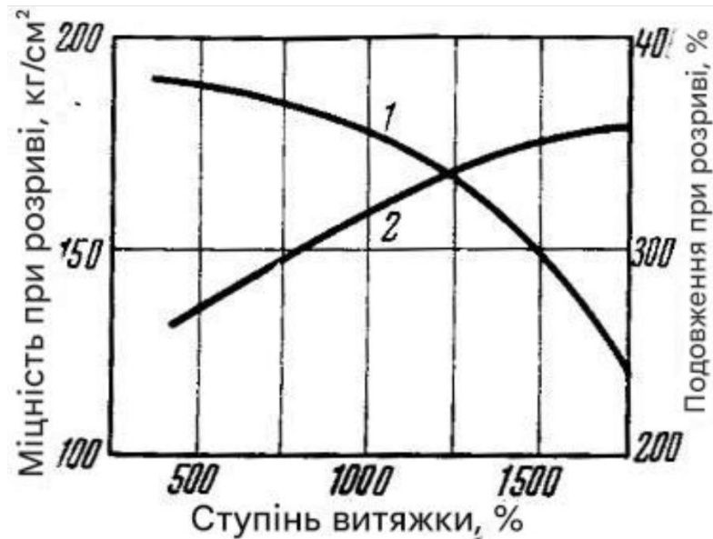
Рисунок 1.9 – Залежність від поздовжньої орієнтації плівки від її механічних властивостей 1 – відносне подовження 2 – міцність на розрив
