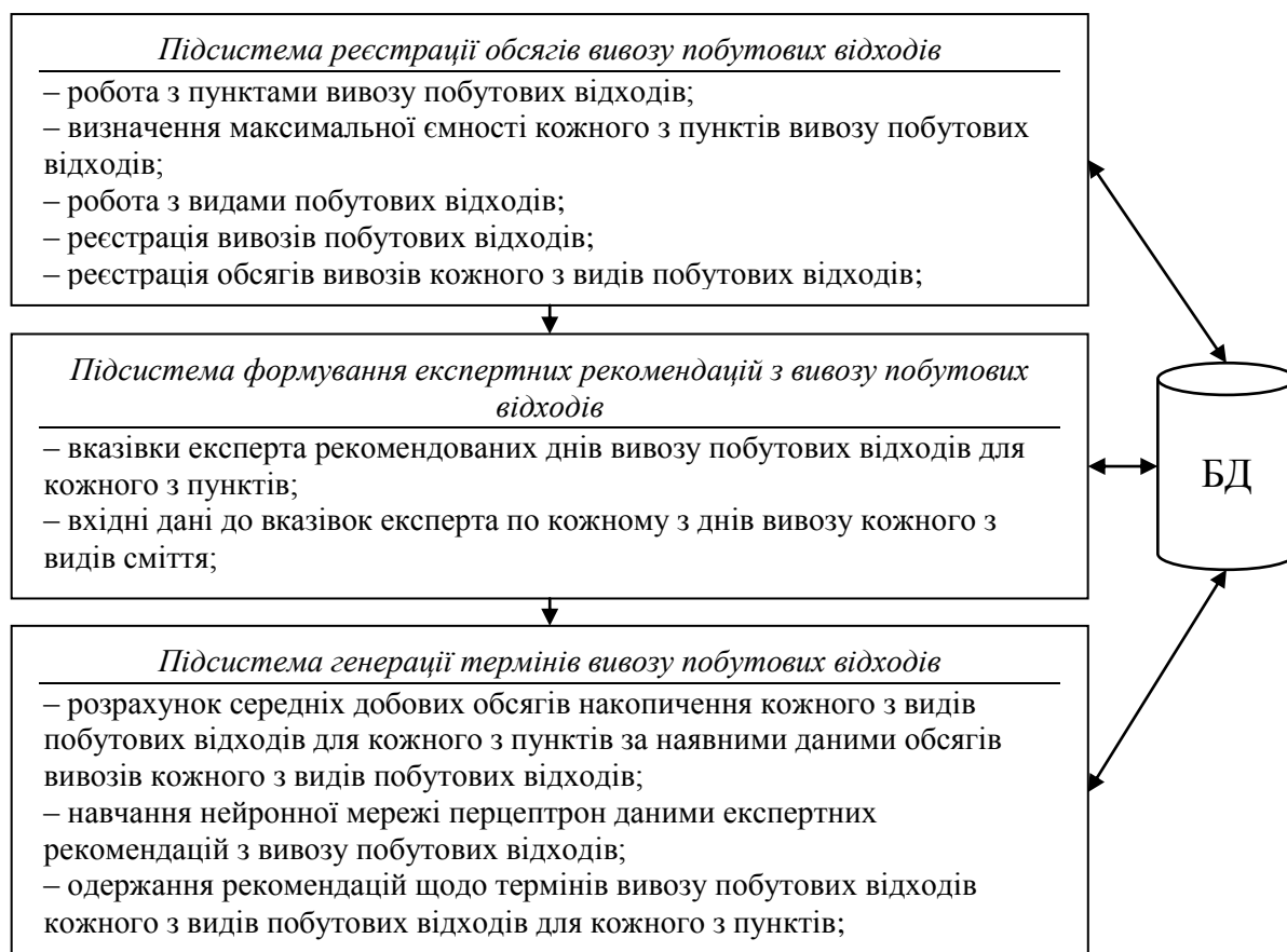
Рисунок 2.2 – Схема мобільного застосунку для автоматизації процесу керування побутовими відходами
