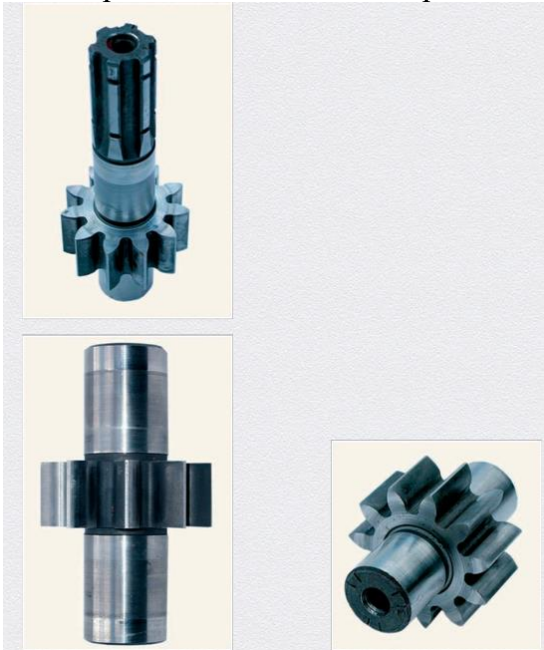
Рисунок Б.26 – Пошкодження шестерень насосу
