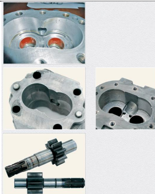
Рисунок Б.29 – Пошкодження бічних поверхонь
