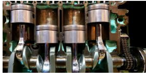
Рисунок Б.4 – Змащування деталей розбризкуванням
