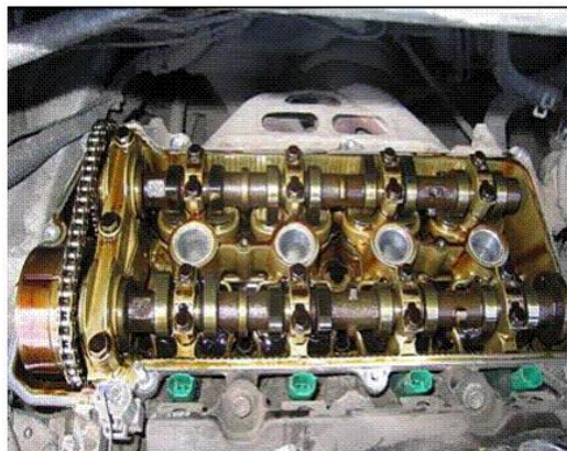
Рисунок Б.3 – Змащування деталей під тиском
