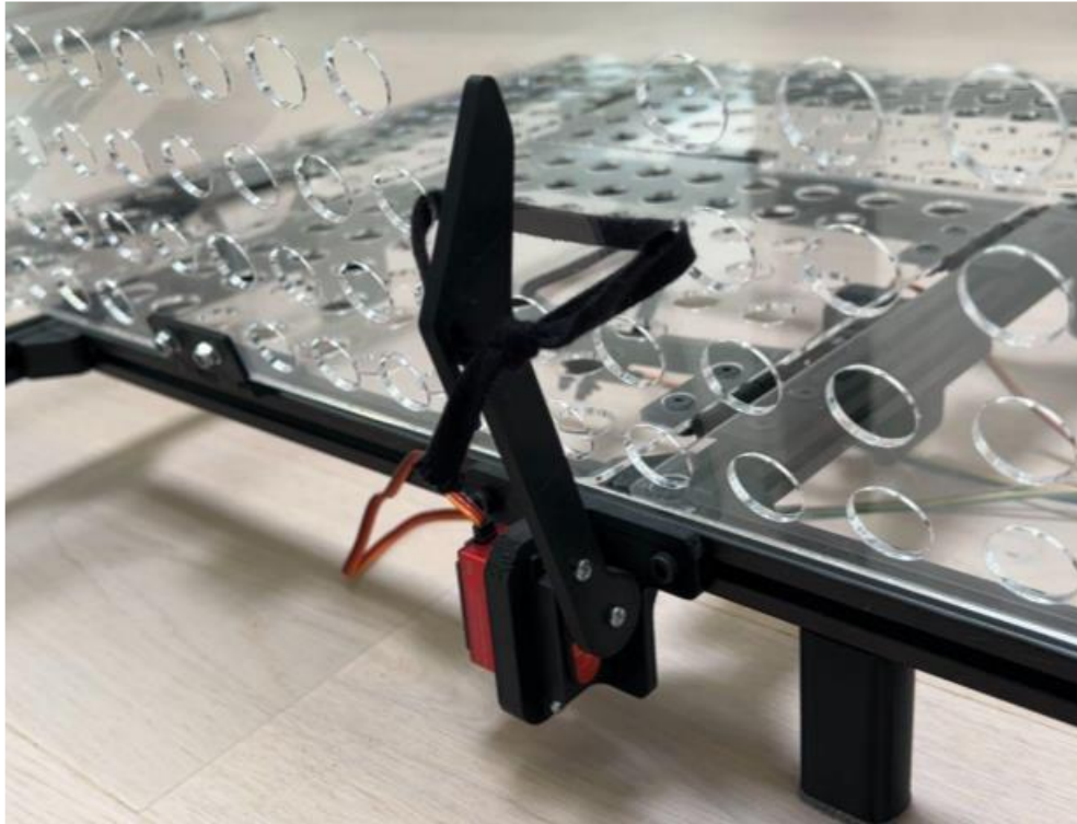
Рисунок 2.14 – Кріплення бічної дошки за допомогою шнурка, що втягується в процесі роботи АССО
