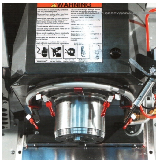
Рисунок 4.1 - Кільцевий механізм подавання мастильно-охолоджувальної рідини фірми Haas
