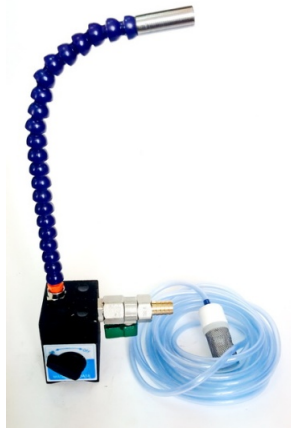
а) розпилювач «InSpray» з магнітною основою і управлінням
