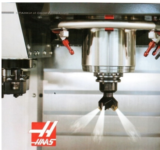
Рисунок4.2 - Додаткова система подавання струменя повітря через інструмент
