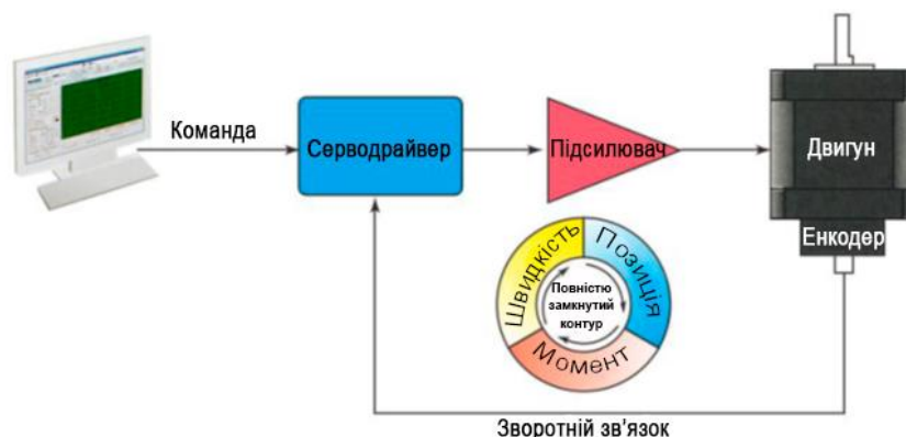
Рисунок 2.13 - Зворотній зв'язок у сервоприводі
