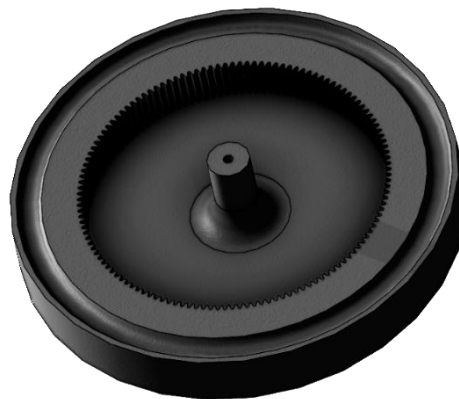
Рисунок 2.7 – Обертова кришка підшипника з внутрішнім зачепленням
