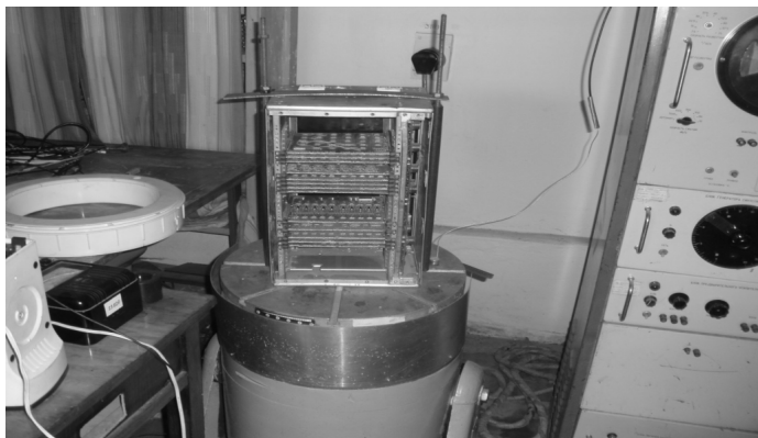
Рис. 1. Лабораторная вибрационная установка для испытания плат
