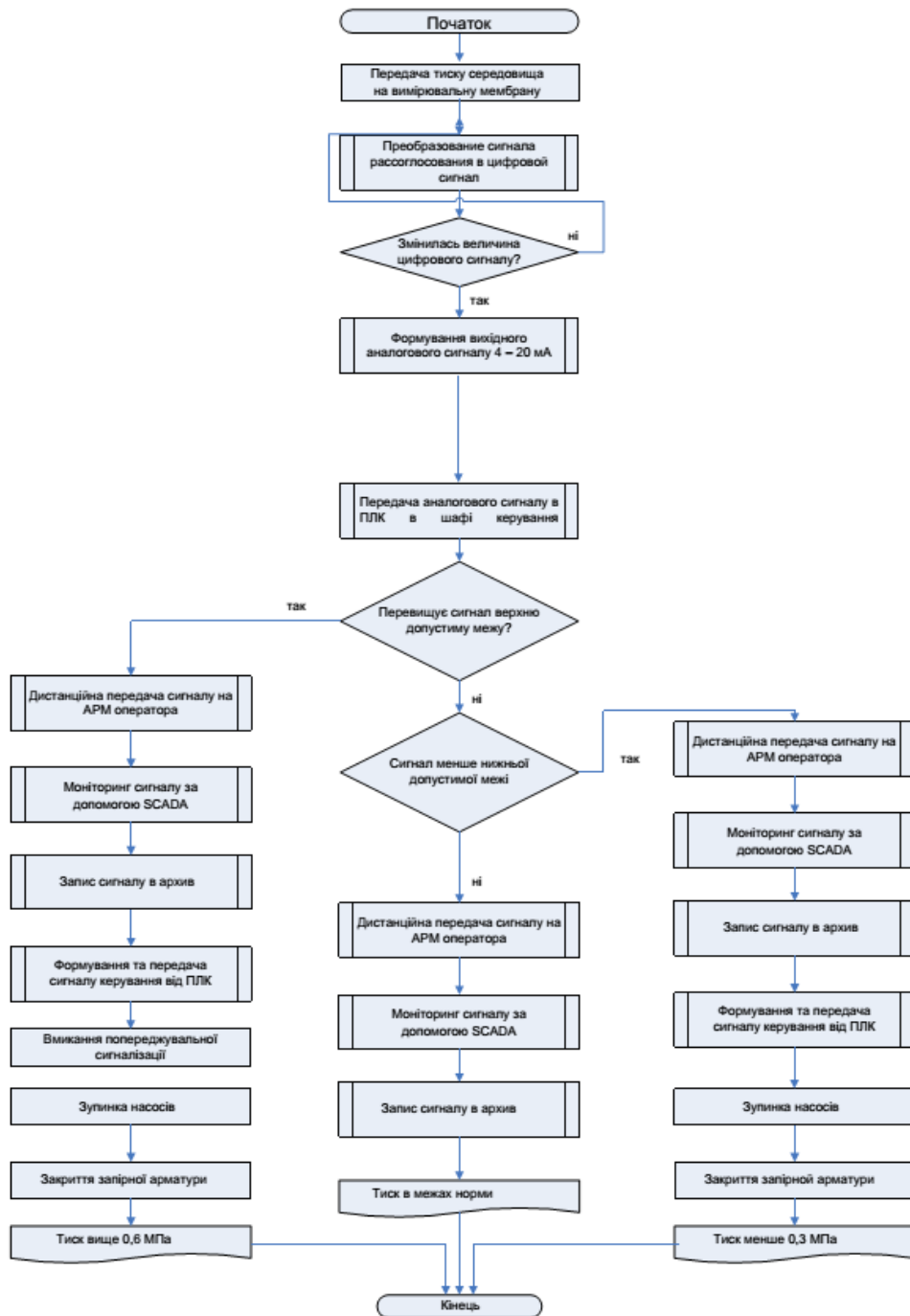
Рисунок 3.4 – Блок-схема алгоритму збору даних з каналу вимірювання рівня тиску
