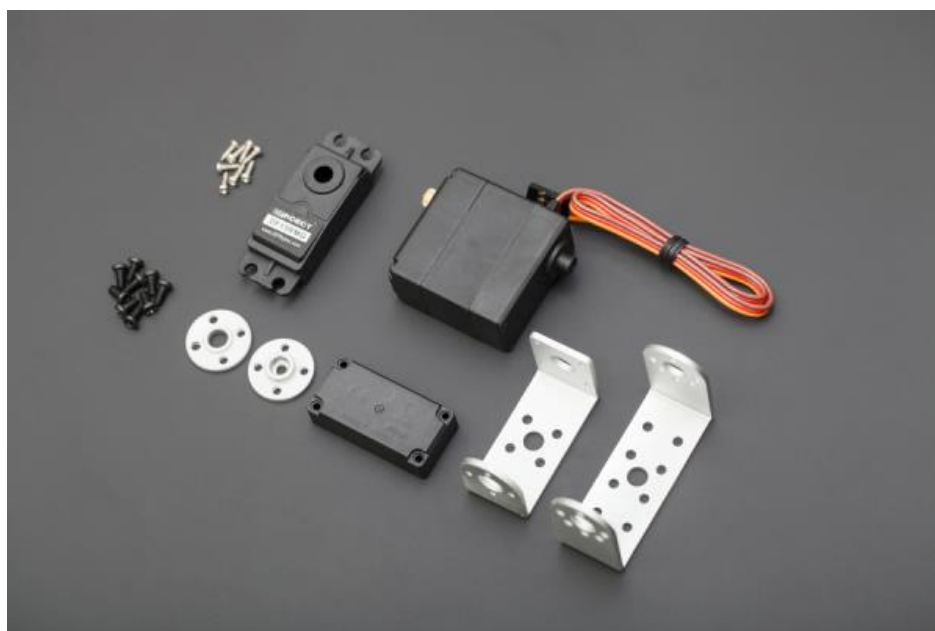
Рисунок 2.3 – Зовнішній вигляд сервоприводу DF15RMG з додатковими кронштейнами
