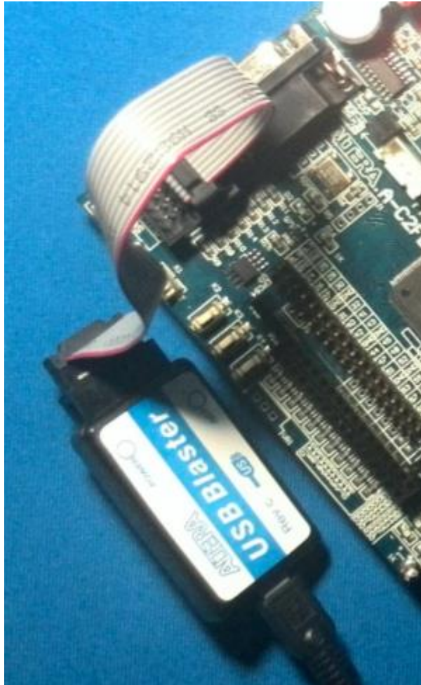
Рисунок 3.7 - Підключення програматора до плати ПЛІС
