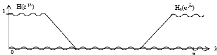
Рис. 2. Частотні характеристики вихідного ЦФ і АФ
