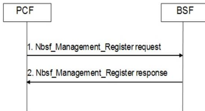
Рисунок 2.5 - Процедур з участю функції прив'язки
