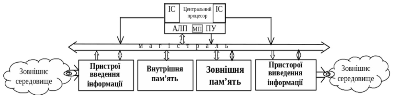
Рисунок 1.2 – Структурна схема одноплатного комп'ютера
