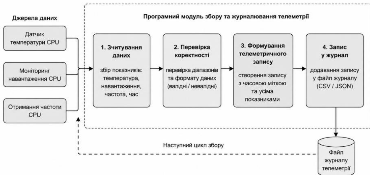
Рисунок 3.2 – Структура роботи програмного модуля збору та журналювання телеметрії
