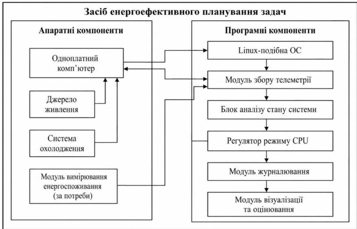
Рисунок 2.2 – Структура апаратних і програмних компонентів засобу енергоефективного планування задач
