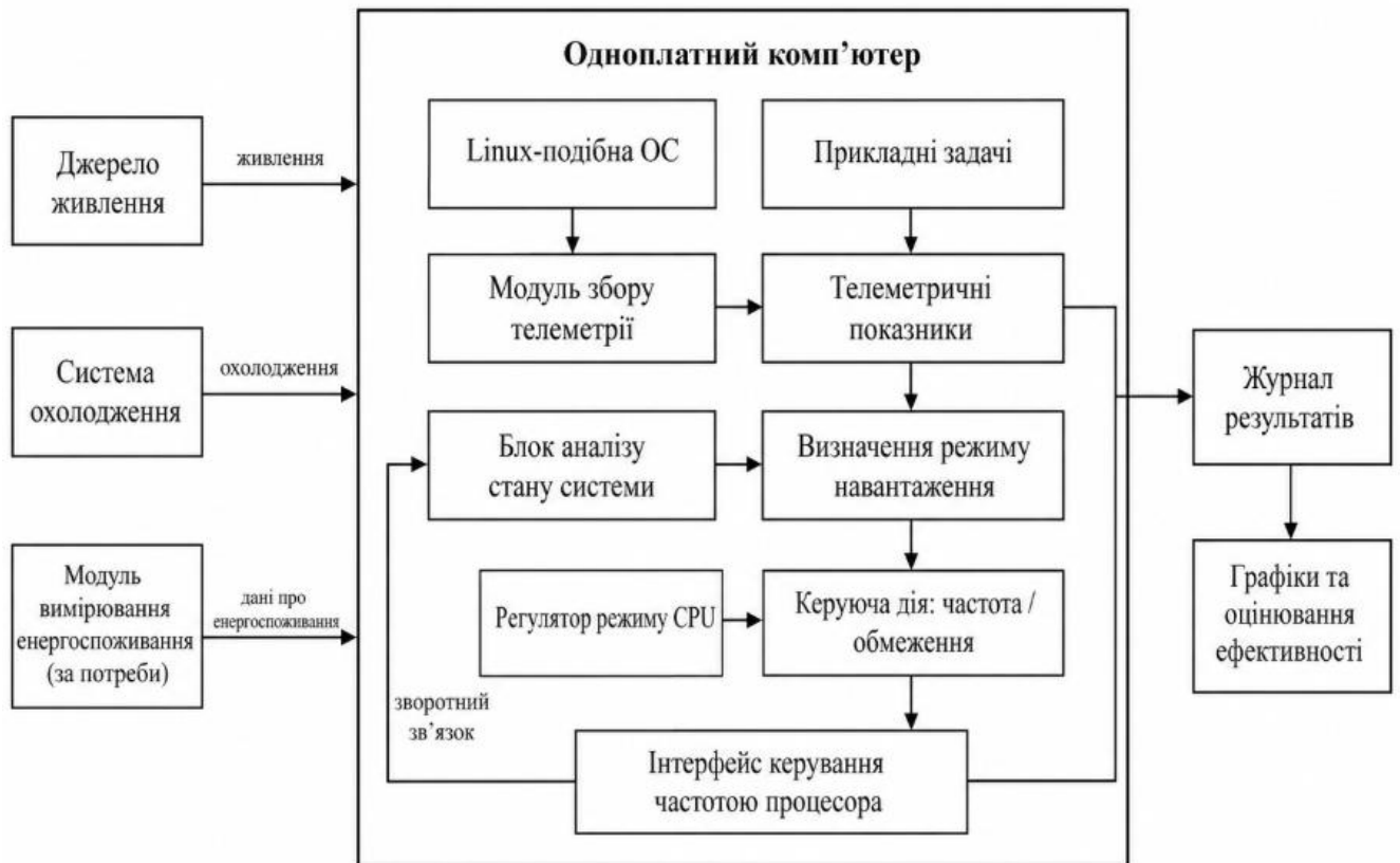
Рисунок 2.1 – Загальна архітектура програмно-апаратного засобу енергоефективного планування задач на одноплатному комп'ютері
