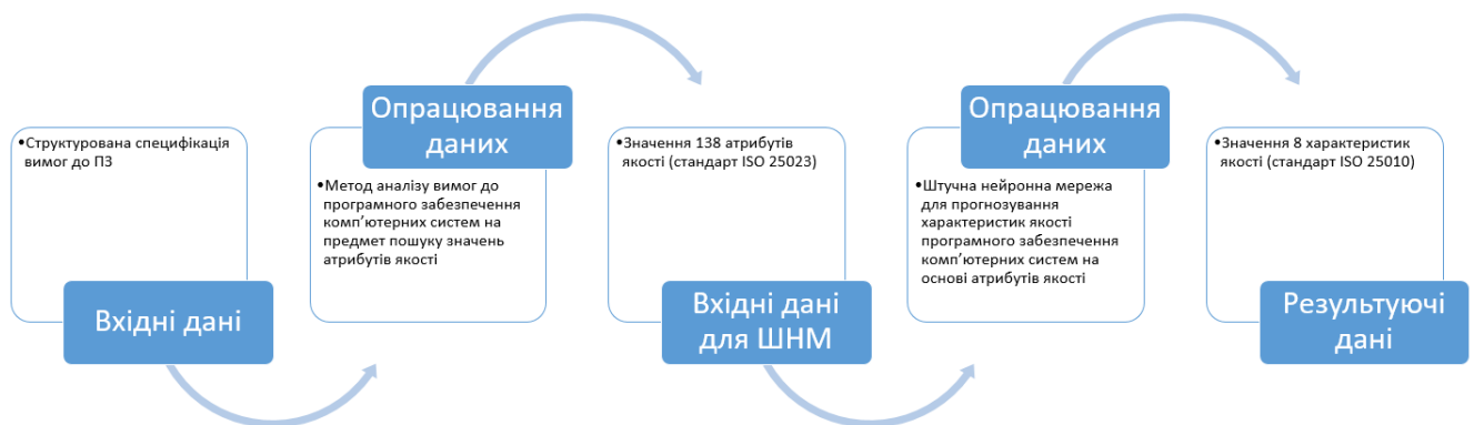
Рис. 2.1 – Концептуальна модель процесу прогнозування характеристик якості програмного забезпечення комп'ютерних систем на основі атрибутів якості
