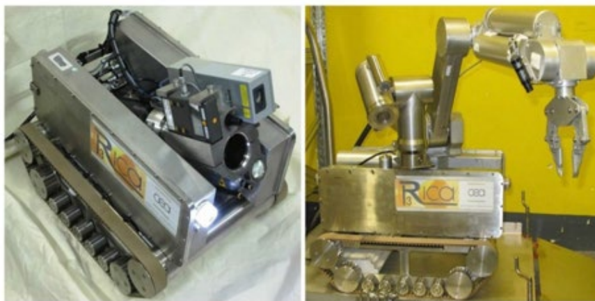
Рисунок 1.5 - Роботизована платформа з гамма-камерою зліва і маніпулятором справа (Ducros and Hauser, 2017)
