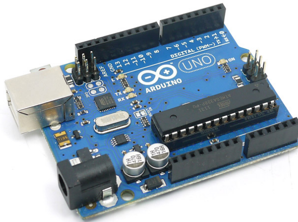
Рисунок 2.1 - Монтажна реалізація елементної бази плати Arduino Uno R3
