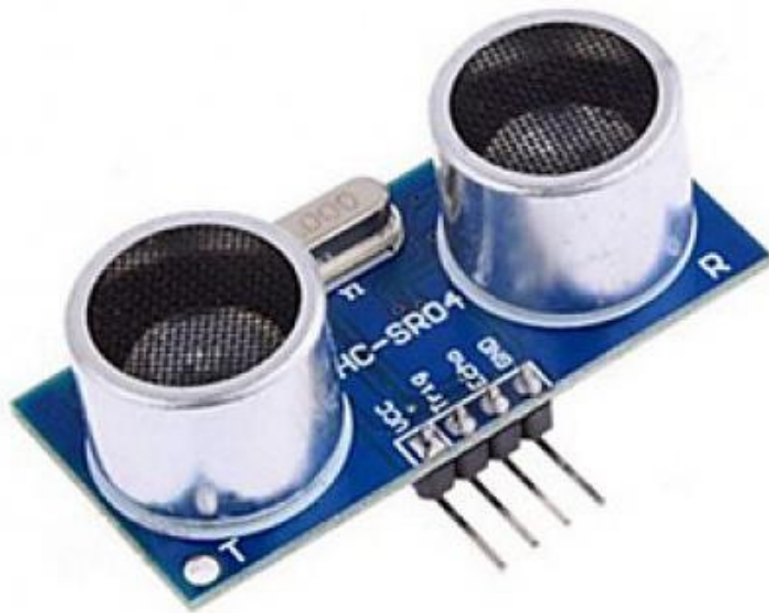
Рисунок 2.9 – Ультразвуковий датчик HC-SR04 [29]
