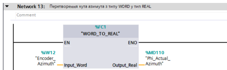
Рисунок 3.17 - Мережа 13: Перетворення кута азимута з типу WORD у тип REAL
