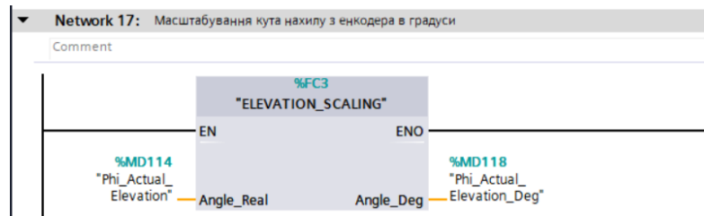
Рисунок 3.21 - Мережа 17: Масштабування кута нахилу з енкодера в градуси
