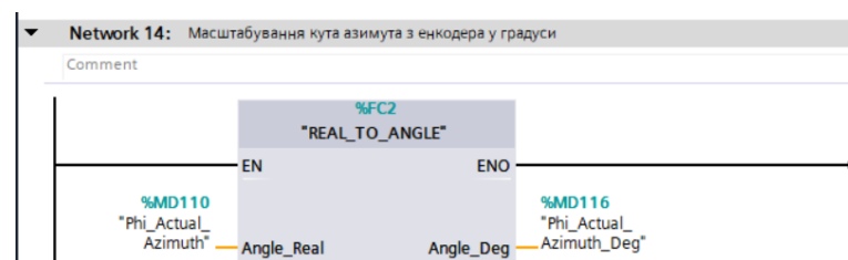
Рисунок 3.18 - Мережа 14: Масштабування кута азимута з енкадера у градуси
