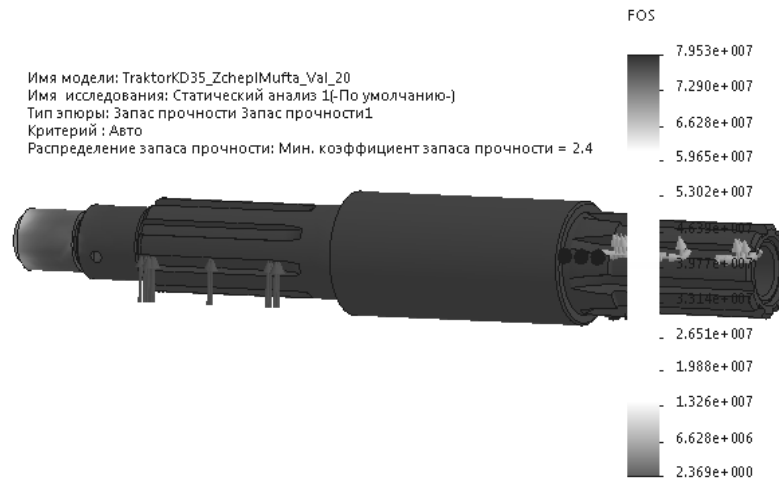
Рис. 4 – Розподіл запасу міцності для сталі 20
