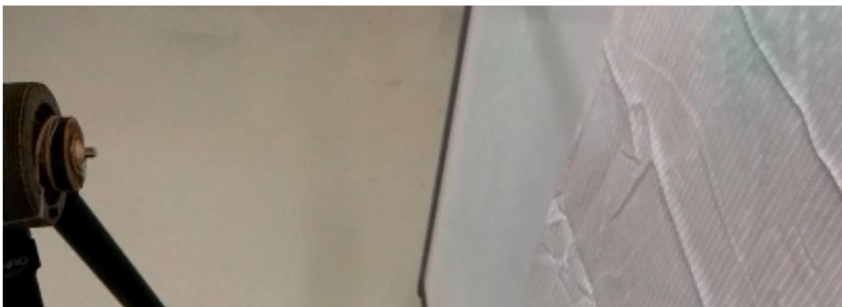
Рис. 3. Процес ультразвукового розпилення та нанесення полімеру на тканину
