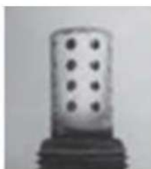
Рисунок 2.12 Вигляд лямбда зонда при несправності
