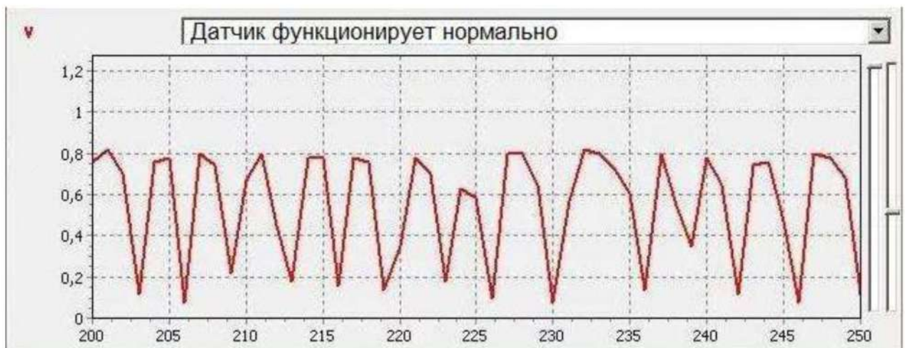
Рисунок 2.6 Осцилограма справного датчика концентрації кисню
