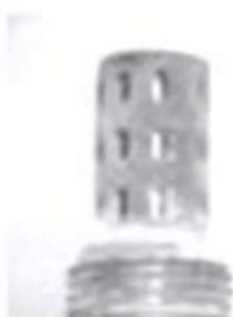
Рисунок 2.7 Вигляд лямбда зонда при нормальній роботі
