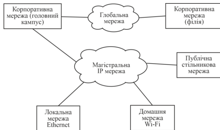
Рисунок 1.2 – Елементи зв'язку та мережі, що використовуються у телекомунікаційній мережі
