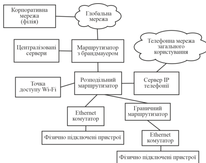
Рисунок 1.3 – Приклад архітектури корпоративної локальної мережі
