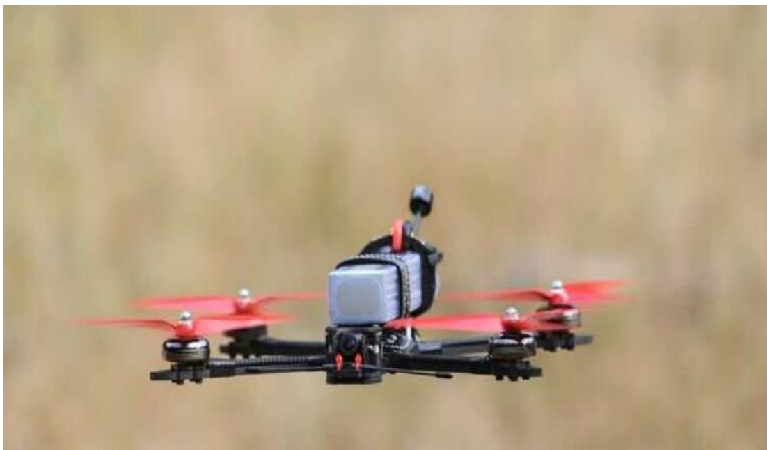
Рисунок 3.3 – Перевірка дрону в польоті на супротив вітру
