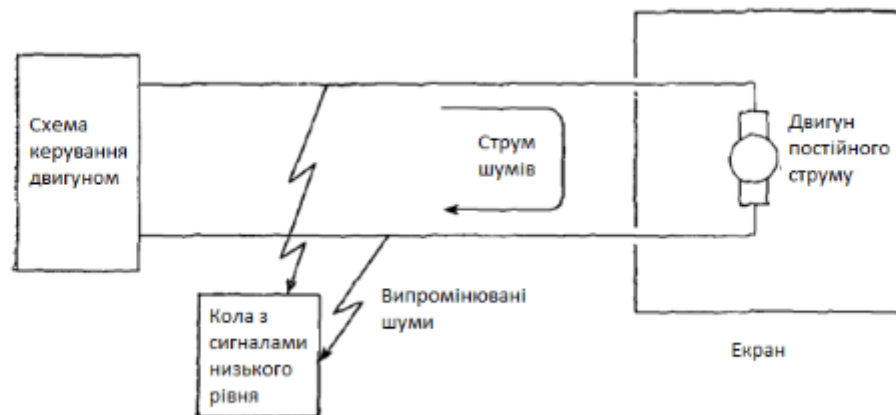
Рисунок 3.1 – Дія шумів від електродвигунів на коло сигналів назького рівня
