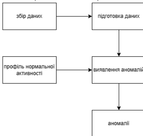
Рис.1 Структурна модель методу виявлення аномалій у DNS-запитах
