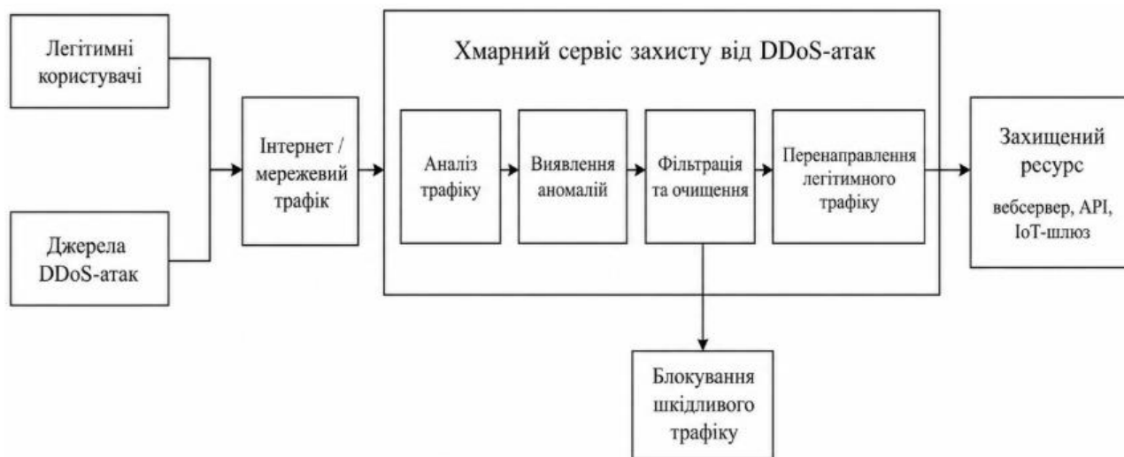
Рисунок 1.2 – Схема роботи хмарного сервісу захисту від DDoS-атак
