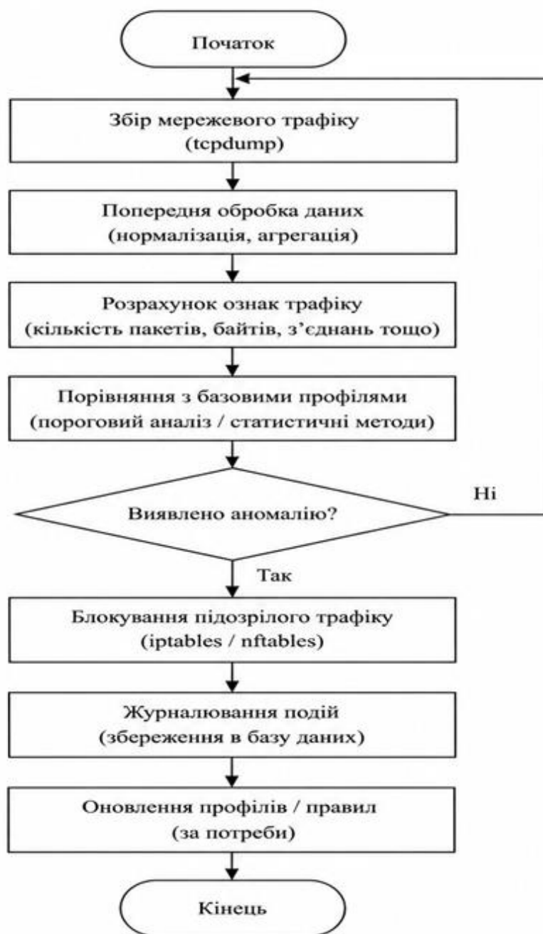
Рисунок 2.4 – Алгоритм виявлення аномального мережевого трафіку
