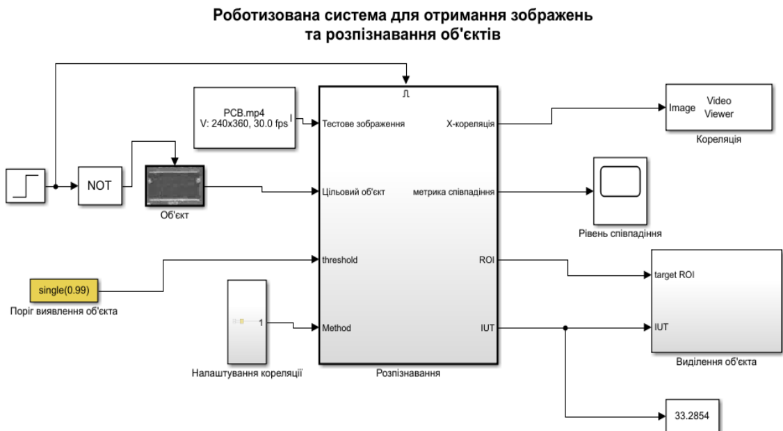
Рисунок 3.1 – Роботизована система для отримання зображень та розпізнавання об'єктів
