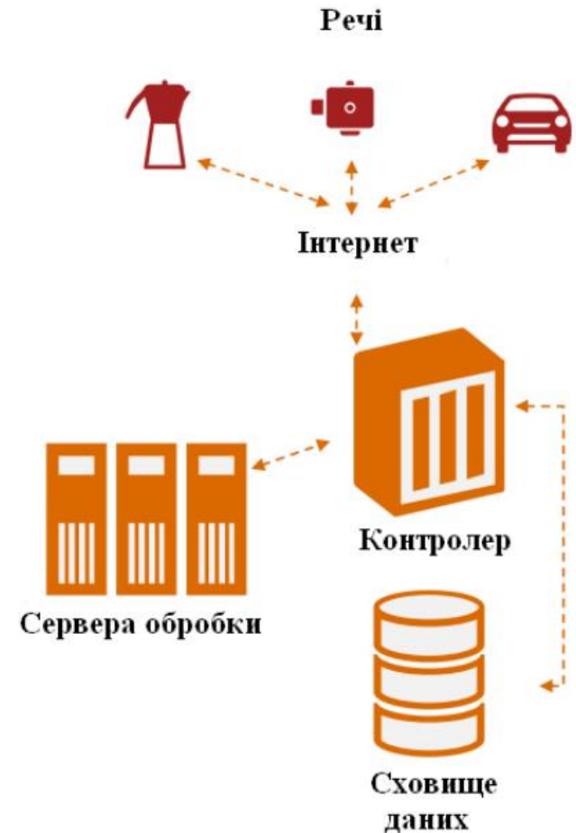
Рисунок 1 – Схема інформаційних процесів між компонентами мережі IoT [2]
