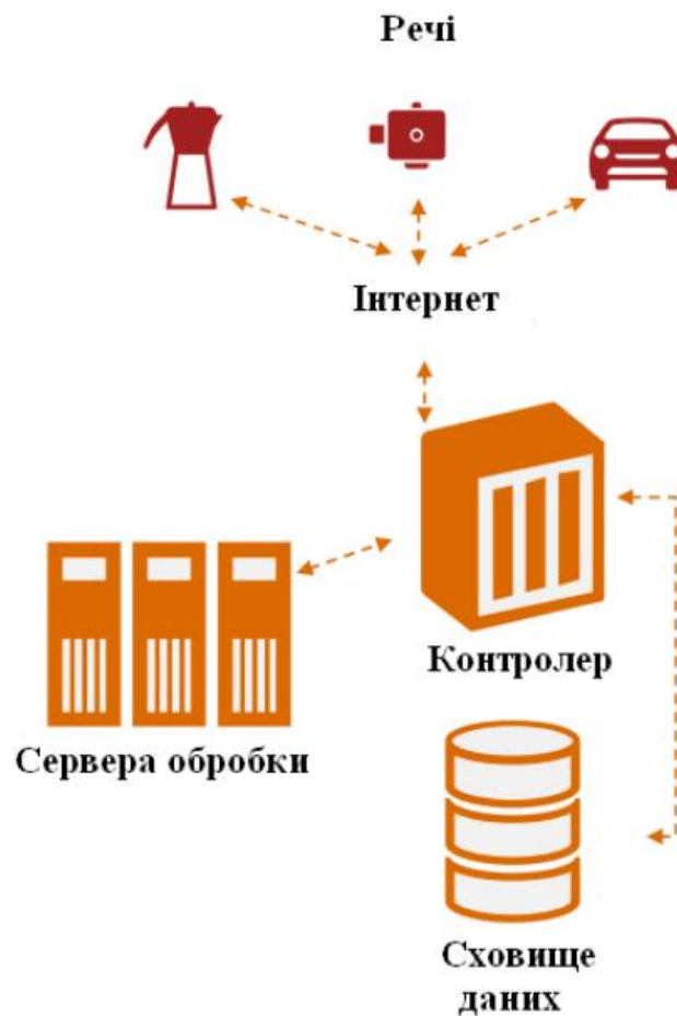
Рисунок 1.1 – Схема інформаційних процесів між компонентами мережі IoT [2]
