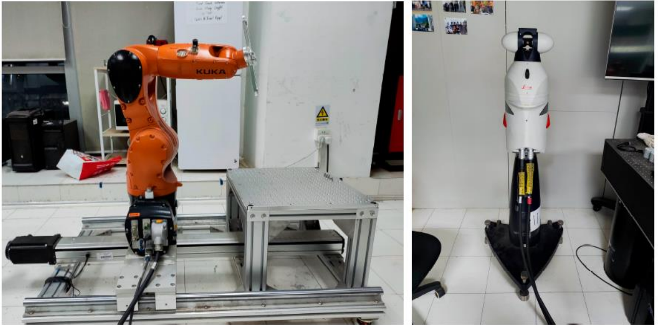
Рисунок 4.3 – Платформа компенсації помилок для лазерних трекерів і промислових роботів
