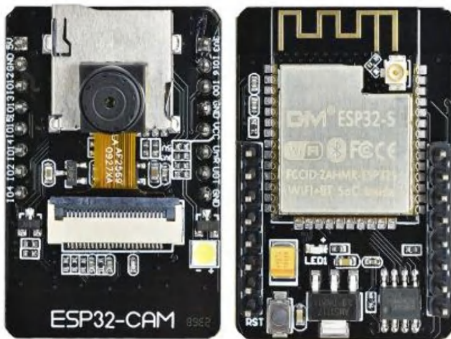
Рисунок 2.11 – Плата з МК ESP32-CAM з двох сторін та відеокамера
