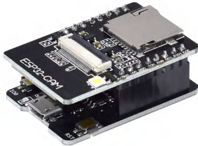
Рисунок 2.10 – Двох-платна система з МК ESP32-CAM та програматором
