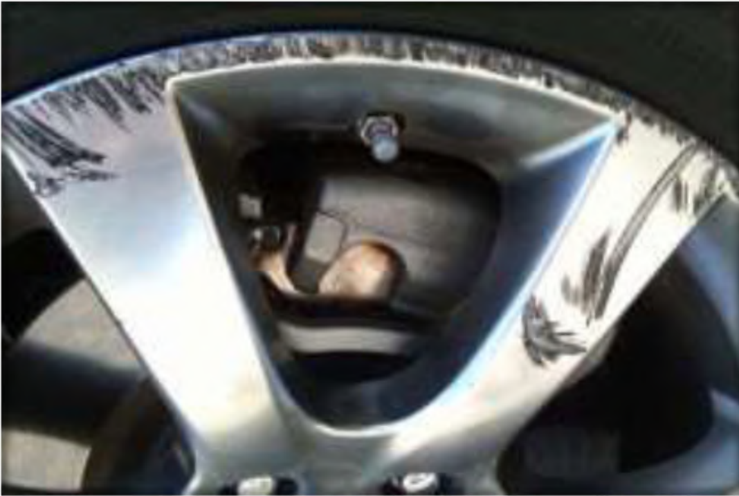
Пошкодження зовнішніх поверхонь
