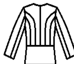
Рис. А.4.4. Верхній одяг відрізний по лінії талії з рельєфами і середнім швом спинки
