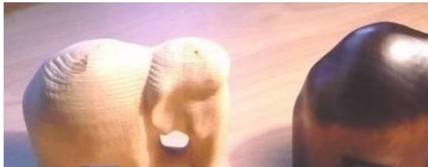
Рисунок 1– Статуетка «мамонт», ліворуч обробка ЧПК, праворуч ручна робота
