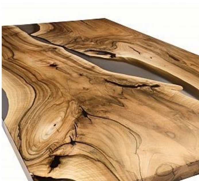
Рисунок 1.6 – Виріб із сучками, який потребує змінних режимів фрезерування.
