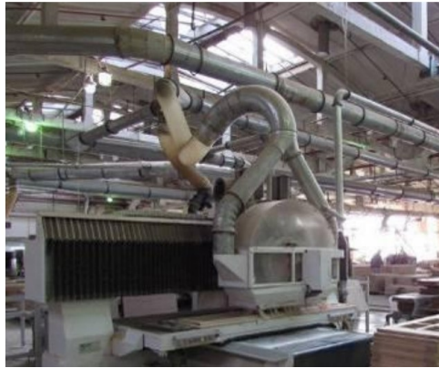
Рисунок 1.4– Дільниця фрезерування декоративних елементів на верстаті з ЧПК
