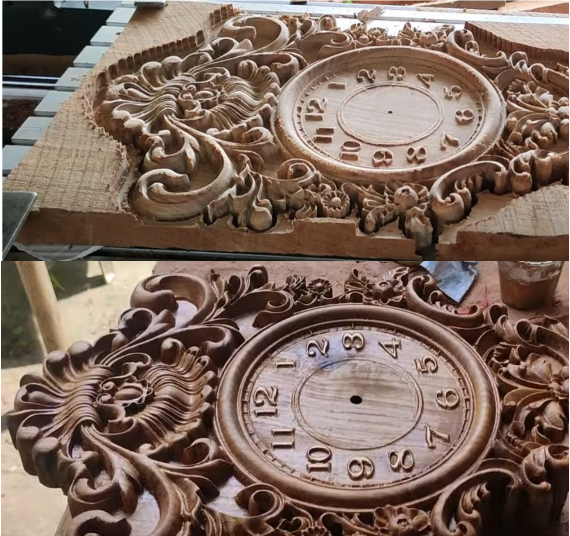
Рисунок 4.8 – Результат адитивного фрезерування виробу
