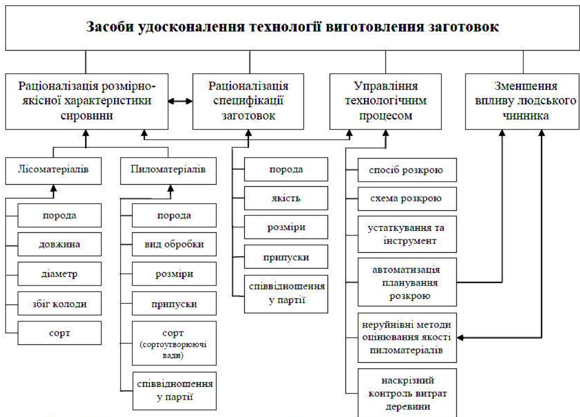
Рисунок 2.4 – Блок-схема основних засобів удосконалення для заготівельної операції деревини
