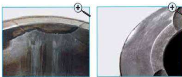
Рис. 2.11. Тріщина гільзи в наслідок гідравлічного удару
