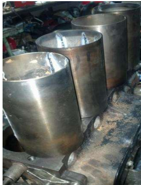
Рис. 2.12. Відновлення гільз методом електродугового зварювання
