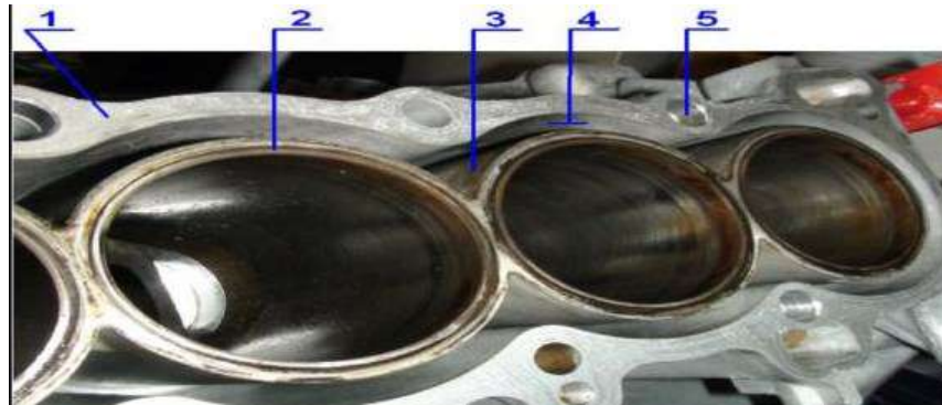
Рис. 2.2. Блок циліндрів з алюмінію
