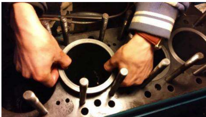
Рис. 2.16. Встановлення гільзи в блок циліндрів
