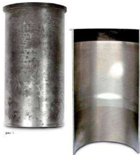
Рис. 2.9. Нерівномірний знос циліндра
