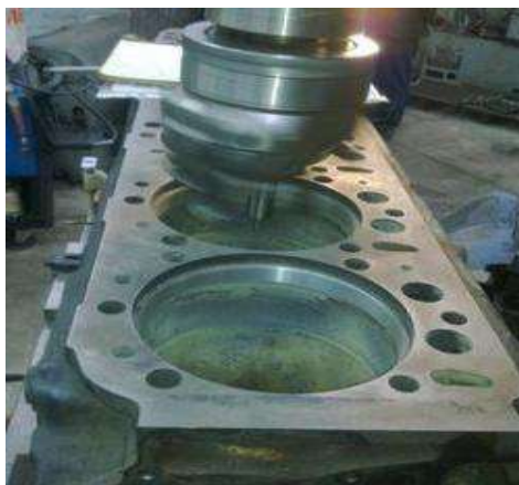
Рис. 2.13. Поглиблення торцевими фрезами гнізд під гільзу
