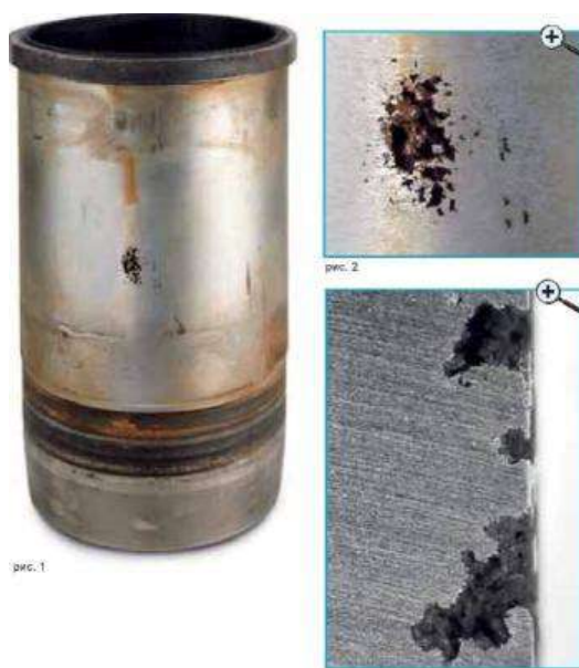
Рис. 2.8. Кавітації на гільзах циліндра
