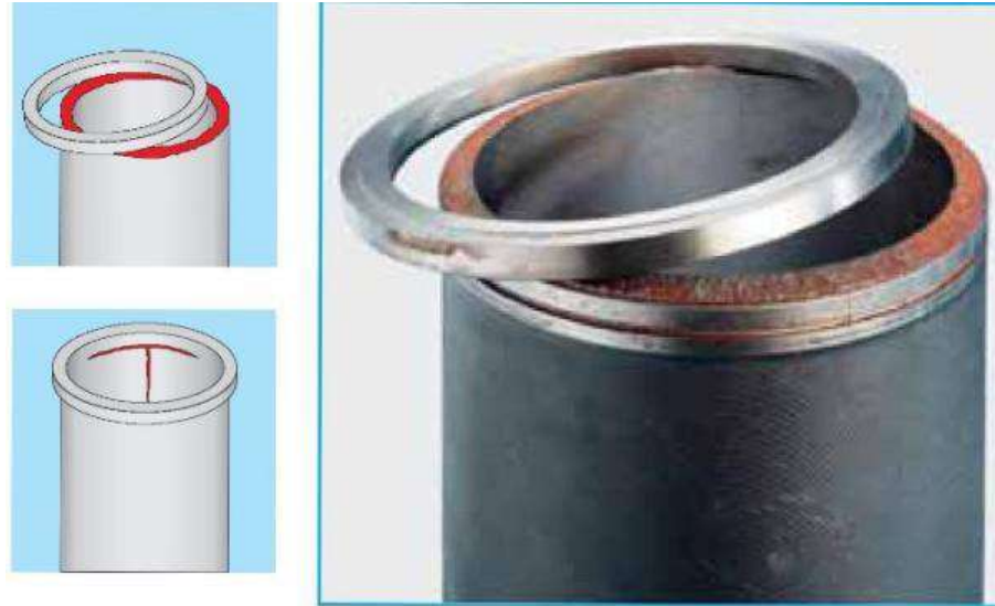
Рис. 2.5. Відламаний буртик гільзи
