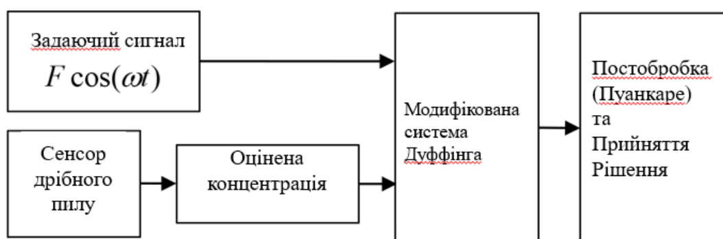
Рисунок 4.1 – Модуль виявлення дрібнодисперсного пилу на основі одного модифікованого осцилятора Дуффінга
