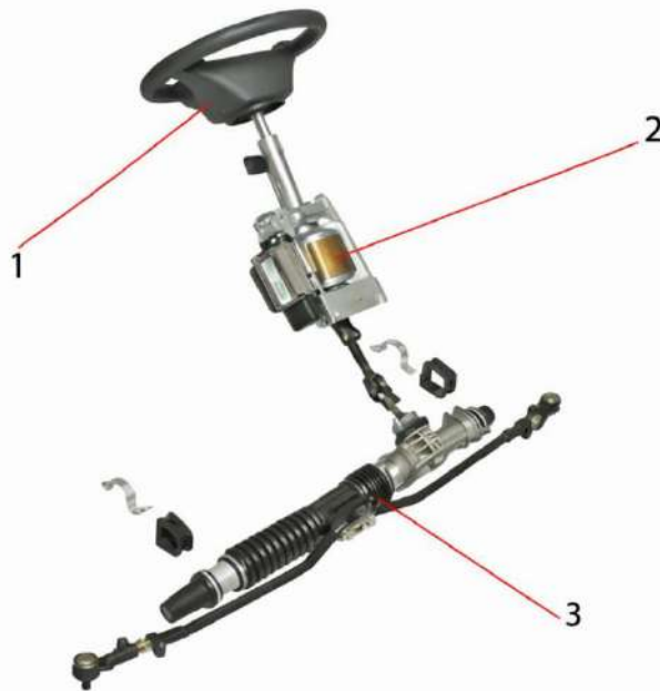
Рисунок 1.4 – Електропривод електропідсилювача рульового управління (структурна компоновка)
