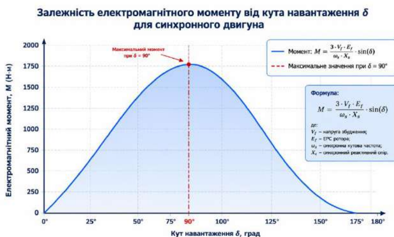
Рисунок 1.8 – Кутова характеристика синхронного електродвигуна
