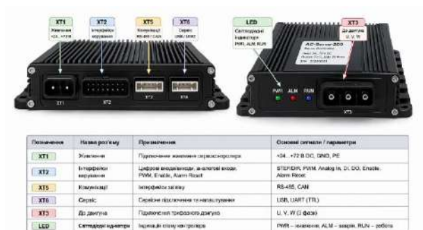
Рисунок 1.7 – Розташування роз'ємів сервоконтролера
