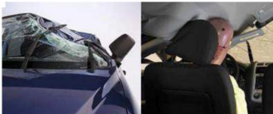
Рисунок 2.4 – Слабкі стійки даху та пошкодження голови водія
