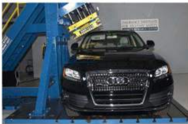
Рисунок 2.5 – Стенд перевірки міцності даху
