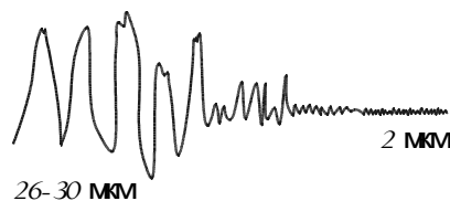
Рис. 3 – Профілограма поверхні після електро-механічного згладжування
