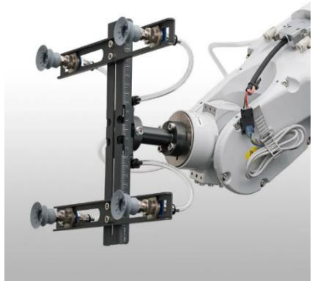
Рисунок 1.7 – Маніпулятор з вакуумними присосками Pisko [5]
