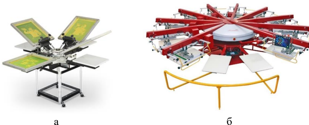
Рисунок 1.4 – Сучасні трафаретні верстати карусельного типу: а) ручний; б) автоматичний планшетний
